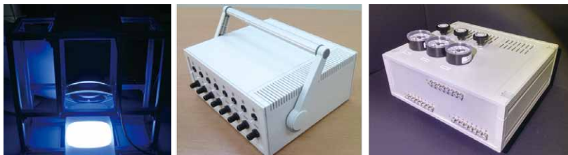
리소그래피 장비(좌), 자동 고전압 조절장치(중), 자동유량제어장치(우)
