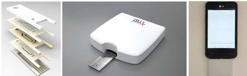
일회용 미세유체칩(좌), 계수시스템 본체(중), 스마트폰 적용시스템(우)
